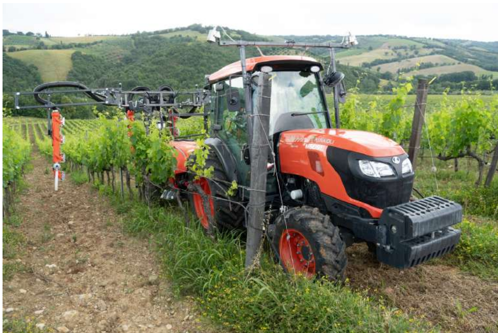
Imagen: Tractor Kubota equipado con sensores Chouette para escanear la presión de las enfermedades en viñedos en las explotaciones de prueba en Italia.
