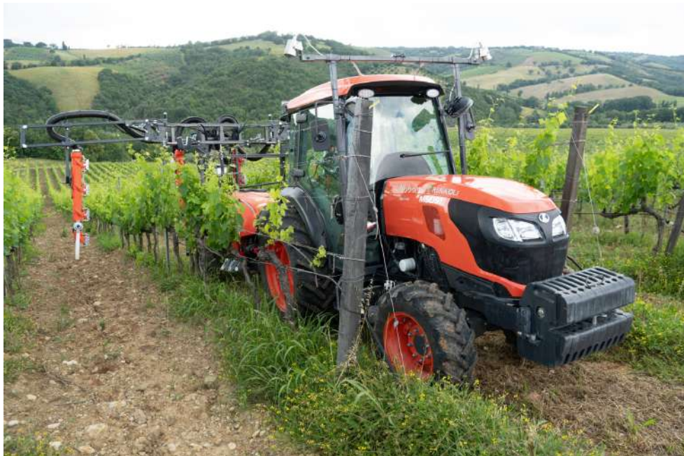
Photo : Tracteur Kubota équipé de capteurs Chouette pour l'analyse de la présence de maladies dans les vignobles dans des fermes expérimentales en Italie.
