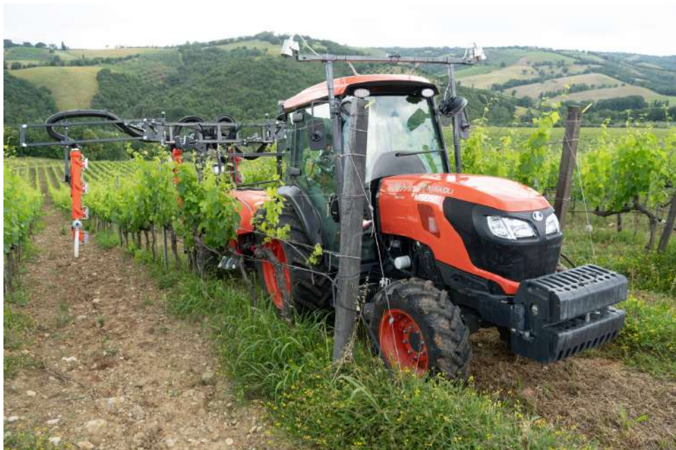
Immagine: Trattore Kubota equipaggiato con sensori Chouette per la scansione della presenza di malattie in vigneti di aziende agricole sperimentali in Italia.
