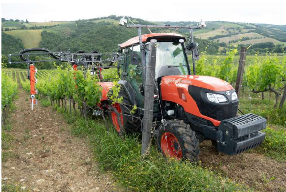
Zdjęcie: Ciągnik Kubota wyposażony w czujniki Chouette do skanowania objawów choroby podczas testów w winnicy we Włoszech.
