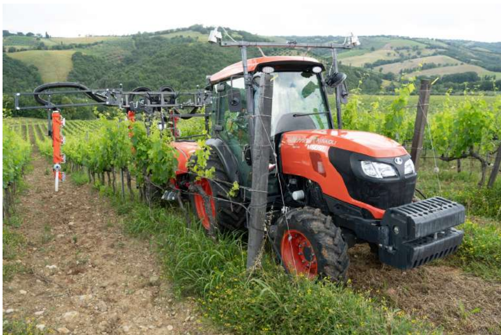
Bild: Kubota-Traktor mit Chouette-Sensoren zur Erfassung des Krankheitsbefalls in Weinbergen auf einem Test-Betrieb in Italien.
