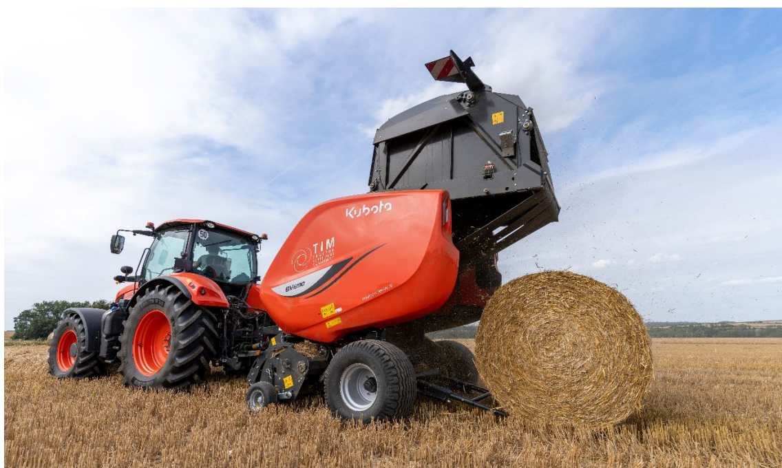
Zdjęcie: Kubota BV6190 zaprojektowana do wysokiej jakości bel o średnicy do 1,85 m
