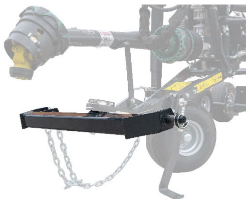
Modernizacja belki zaczepowej
