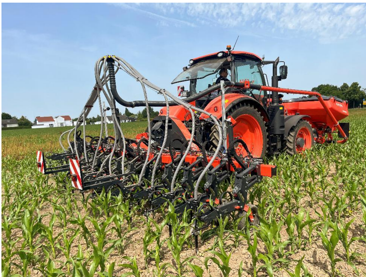
Aplicación de abono con la binadora Kubota IC3000F, tolva frontal SH1600 y cabezal de distribución
