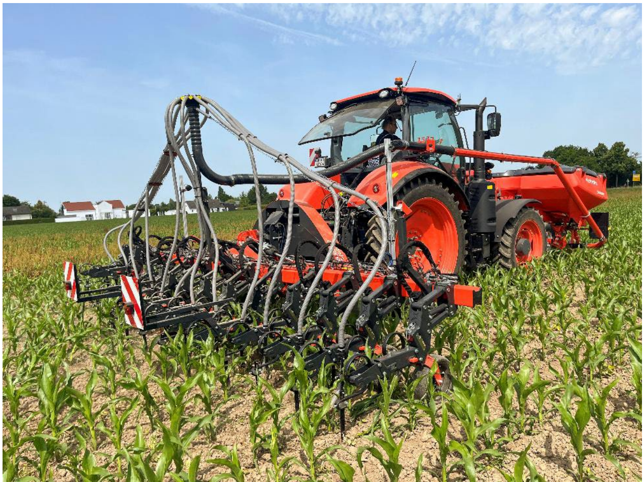
Düngung während der Unkrautbekämpfung mit dem Kubota IC3000F, Fronttank SH1600 und dem Verteilerkopf auf der Hacke
